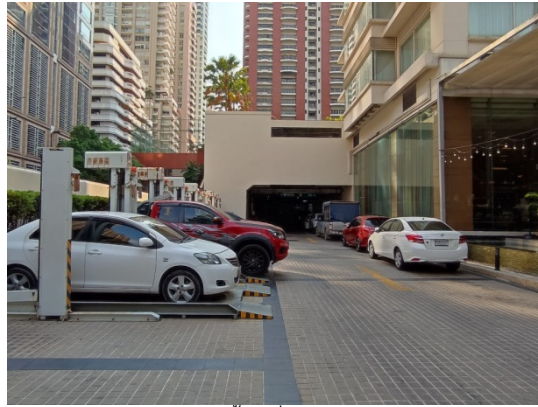
ภาพที่ 4-7 ที่จอดรถแบบ 2 Layer Lifting-Sliding Type ติดตั้งไว้ที่ทิศตะวันตกและทิศตะวันออกของโครงการอยู่ระหว่างซอยแฉ่ม
